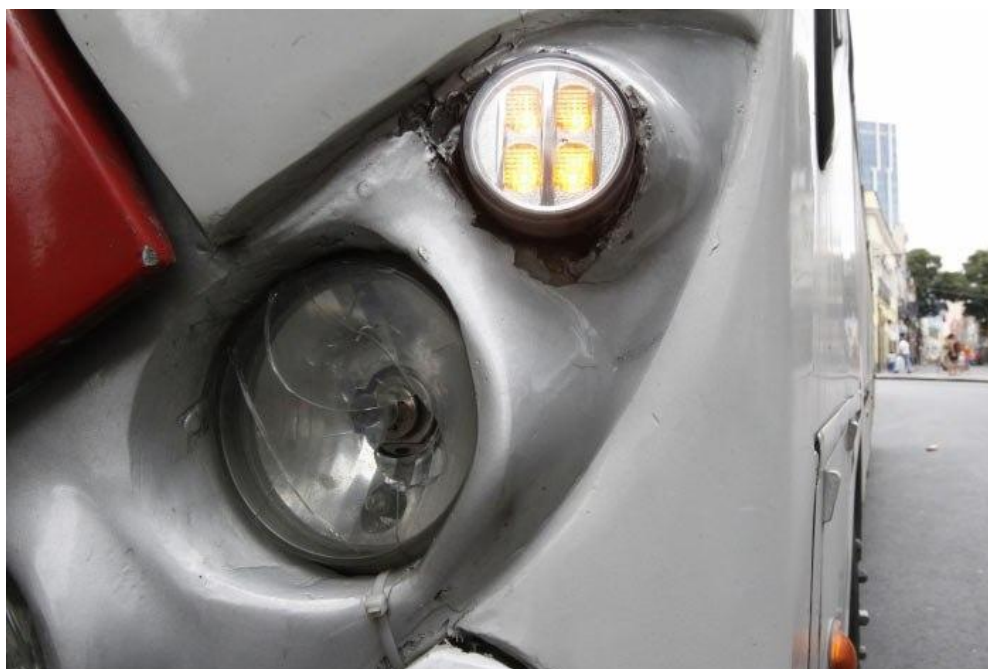
Ônibus da linha 850 circula com um dos faróis e lanternas quebrados
