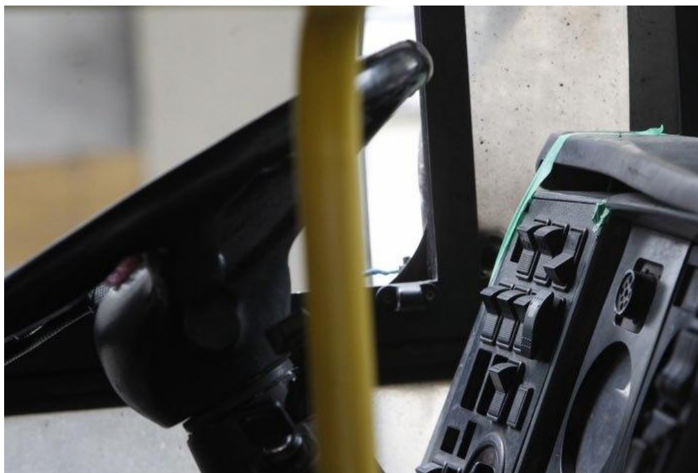
Carro da linha 398 usa fita adesiva para sustentar painel de comandos
